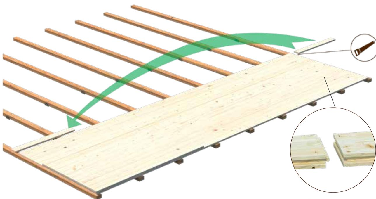
Tenons aux extrémités de lames de plancher
